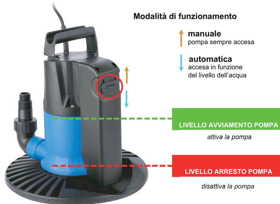
Nella modalità automatica, quando il livello dell'acqua raggiunge il livello di avviamento, la pompa inizia a funzionare e quando il livello dell'acqua scende al livello di arresto, la pompa smette automaticamente di funzionare.
